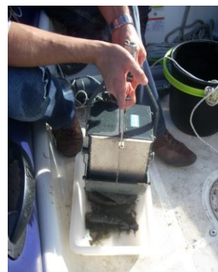
Toma de muestras de sedimento con draga
