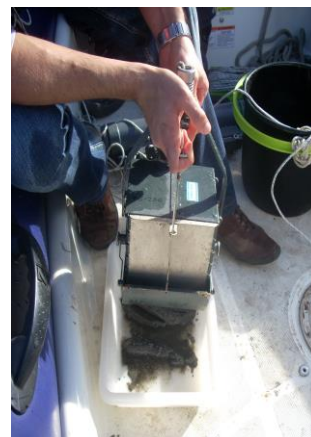
Toma de muestras de sedimento con draga
