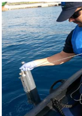
Toma de muestras con botella oceanográfica (muestras integradas)
