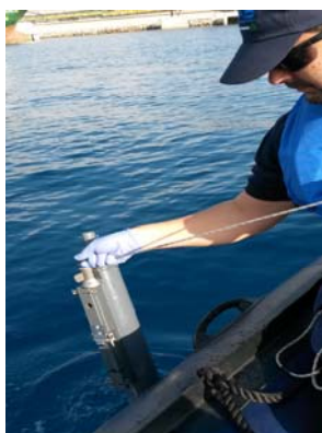
Toma de muestras con botella oceanográfica (muestras integradas)
