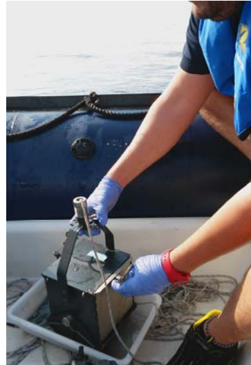
Toma de muestras de sedimento con draga
