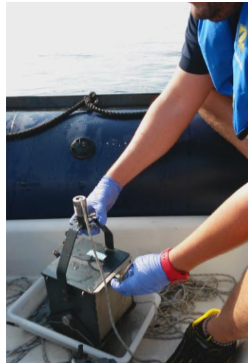
Toma de muestras de sedimento con draga
