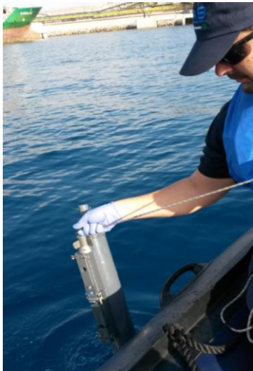
Toma de muestras de agua con botella oceanográfica (muestras integradas)
