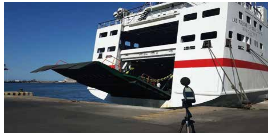
Campaña de ensayos "in situ" con el fin de caracterizar acústicamente los diferentes focos de ruido presentes en el puerto.
