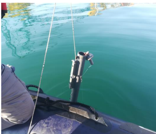
Toma de muestras con botella oceanográfica (muestras integradas)
