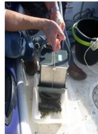
Toma de muestras de sedimento con draga
