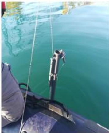
Toma de muestras con botella oceanográfica (muestras integradas)
