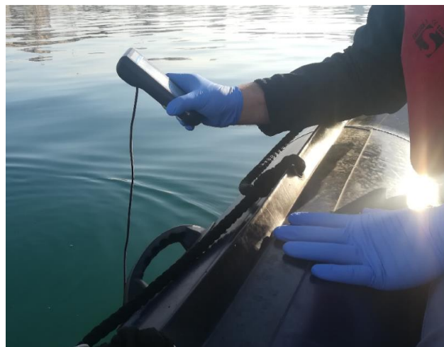
Procedimiento de registro de variables con multiparamétrico
