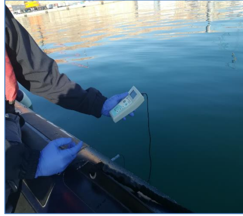
Imágenes 1 y 2: Toma de muestras integradas con botella oceanográfica (a la izquierda) y procedimiento de registro de variables con equipo multiparamétrico (a la derecha).
