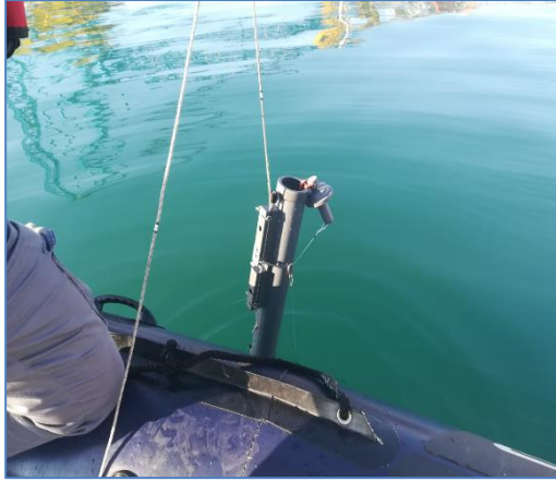
Imágenes 1 y 2: Toma de muestras integradas con botella oceanográfica (a la izquierda) y procedimiento de registro de variables con equipo multiparamétrico (a la derecha).
